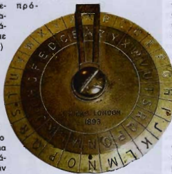
Περιστρεφόμενος δίσκος αλφαβητικής αντιμετάθεσης γραμμάτων για την κρυπτογράφηση μηνυμάτων. Πρώμη εκδοχή αυτού του συστήματος αποτελεί το κωδικό μοιρογμωνίου του Ανεία, ενώ παρόμοιες σκακίες σαν αυτή της εικόνας (1893) χρησιμοποιήθηκαν έως και τον Β' Παγκόσμιο Πόλεμο στα πεδία των μαχών.
