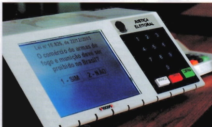
Οι ηλεκτρονικές άμεσες καταχώρισης ψήφου (Direct-Recording Electronic - DRE voting machines) αποτελούν σήμερα την πιο συνηθισμένη μορφή ηλεκτρονικής ψηφοφορίας. Κατά κανόνα δεν υλοποιούν μια αμιγυρά εξ αποστάσεως ψηφοφορία αλλά απλά μια αποκεντρωμένη διαδικασία ηλεκτρονικής ψηφοφορίας, η οποία διεξάγεται με τυπικό τρόπο σε εκλογικά κέντρα. Η διαφορά έγκειται στο ότι, μέσω των συσκευών αυτών, το αδιάβλητο του αυστηρά βασίζεται κυρίως σε κρυπτογραφικές μεθόδους, άρα απαιτείται πολύ πιο περιορισμένη υποδομή, και επιπλέον η καταχώριση και καταμέτρηση γίνεται σχεδόν σε πραγματικό χρόνο.
