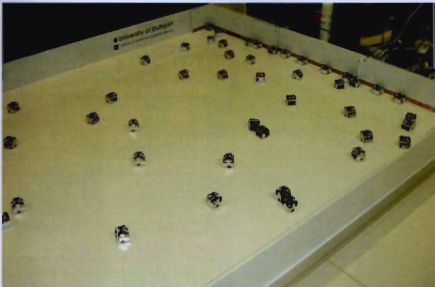
Πειραματική διάταξη -έξυπνου- σμήνους από αυτόνομους απλούς ρομποτικούς μηχανισμούς, οι οποίοι συνδυάζονται μέσω αυτο-οργάνωσης προκειμένου να δημιουργήσουν κάτι πιο σύνθετο.
