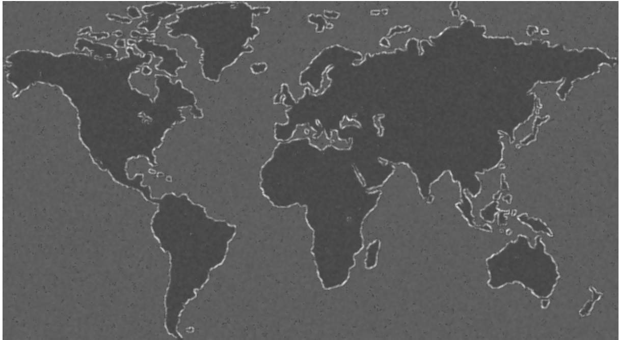
Εικόνα 2.4.β - Όξυνση εικόνας με διαφόριση Sobel και κατώφλι T=70
