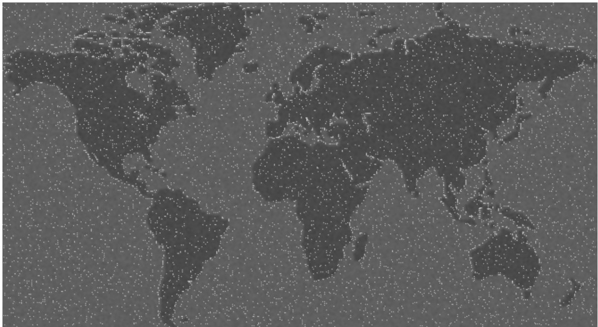
Εικόνα 2.4.γ - Όξυνση εικόνας με Laplacian μάσκα τύπου 1 και κατώφλι T=170
