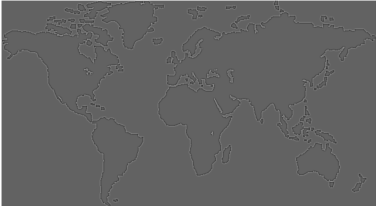
Εικόνα 2.3.γ - Ανάδειξη ακμών με Laplacian μάσκα τύπου 2
